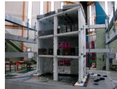
Maquette SMART sur table vibrante CEA-EDF Projet
